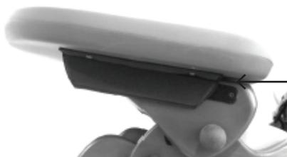
Para ajustar la inclinación de la bandeja, afloje los pernos redondeados y reposicione el ángulo de soporte de la bandeja en ambos lados.
