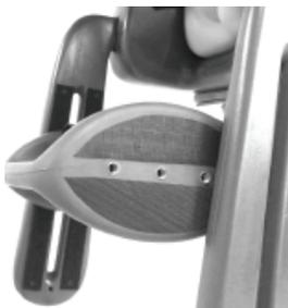
Para ajustar la profundidad de los reposapiés, hay 3 agujeros que permiten el ajuste de la profundidad. Quite los pernos redondeados y reposicione los reposapiés a la profundidad deseada. Vuelva a colocar los pernos redondeados y apriételes firmemente.
