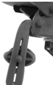
Para ajustar los reposapiés a la altura y ángulo deseados, afloje los pernos redondeados de goma en ambos lados y reposicione el Velcro. Apriete los pernos para ajustar la posición de los reposapiés. Para ajustar la profundidad de las barras de los reposapiés, quite los tornillos estrellados y reposicione hasta conseguir la profundidad deseada. Vuelva a colocar los tornillos estrellados.
