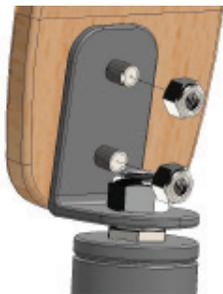
Beachten Sie, dass Lenkrollen, dass Lenkrollen mit Bremse an der Rückseite der Basis montiert werden. Dies erhöht die Stärke der Basis. Bitte achten Sie auf festsitzende Schrauben.
