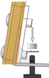
Führen Sie den nichtmobilen Gleiter durch die Basishalterung nach oben. Montieren Sie Unterlegscheiben dann die Mutter. Hinweis: Bitte achten Sie auf festsitzende Schrauben.
