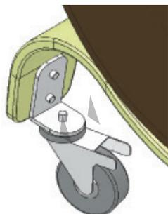
Achten Sie darauf, dass die Rollen mit Bremse auf der Rückseite des Basis installiert sind. Dies erhöht die Basisstärke. Bitte achten Sie auf festsitzende Schrauben
