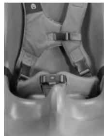
PASO 6 Vuelva a colocar el clip derecho de la parte inferior enganchado en el arnés torácico.
